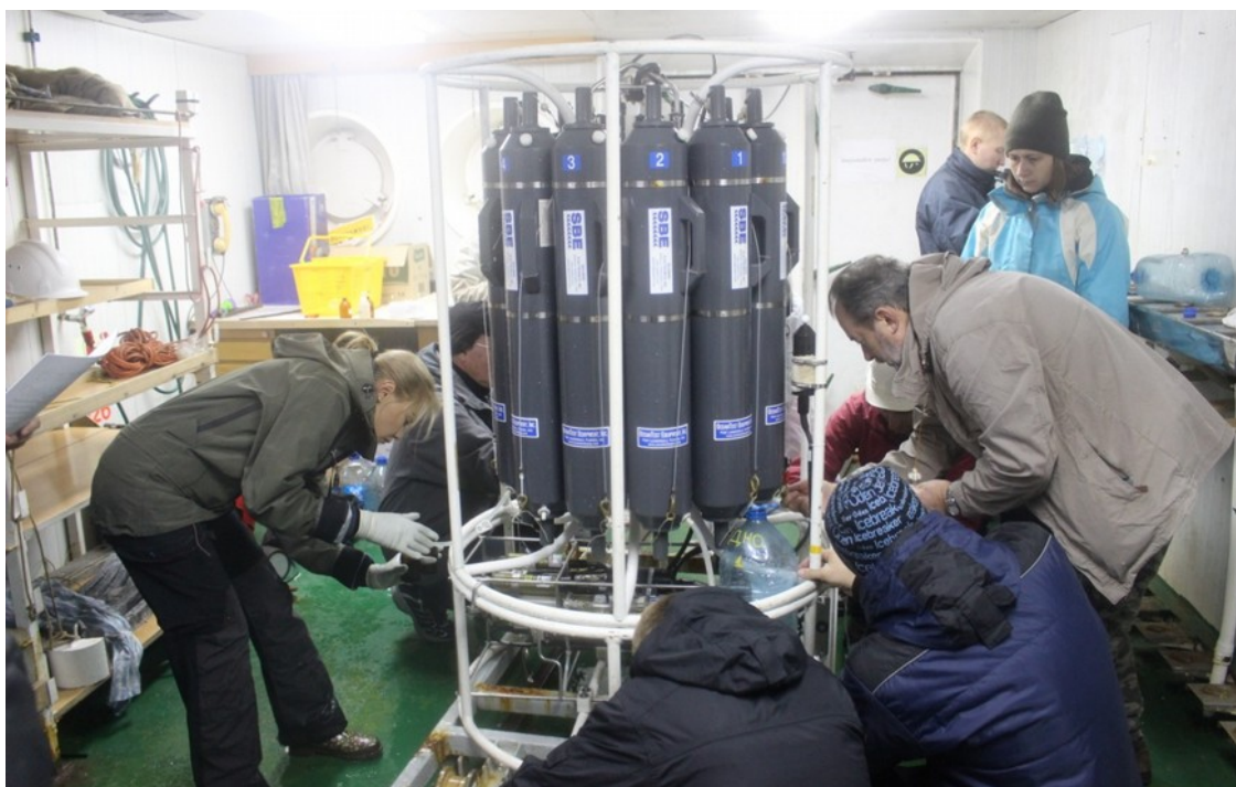
Рисунок 11. Отбор проб воды
