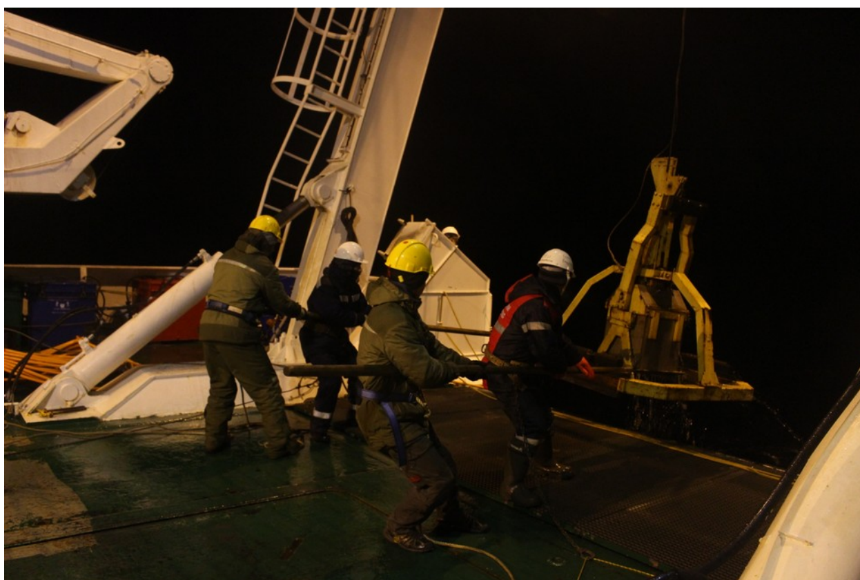
Рисунок 12. Процесс работы с бокс корером
