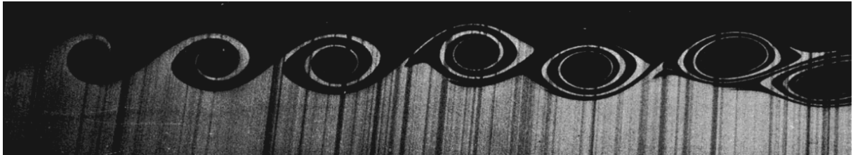
Рис. 1.3.3. Сдвиговая неустойчивость. Нижний поток движется влево быстрее, чем верхний. Рисунок заимствован из альбома [Ван-Дайк, 1986].
