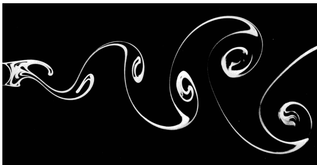
Рис. 1.3.6. Вихревая дорожка Кармана за круговым цилиндром при Re=140 . Рисунок заимствован из альбома [Ван-Дайк, 1986].
