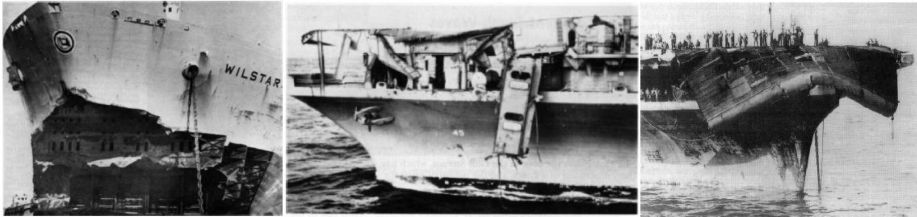
Рис. 1. Фотографии повреждений, вызванных экстремальными волнами
