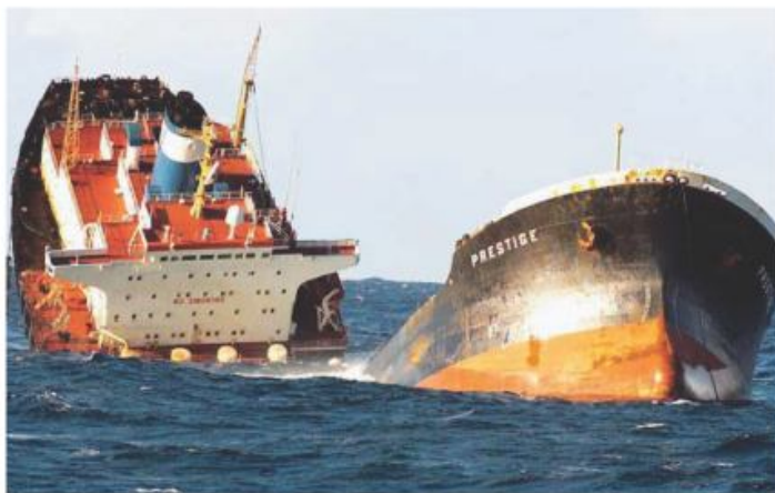
Рис. 1. Фотографии повреждений, вызванных экстремальными волнами
