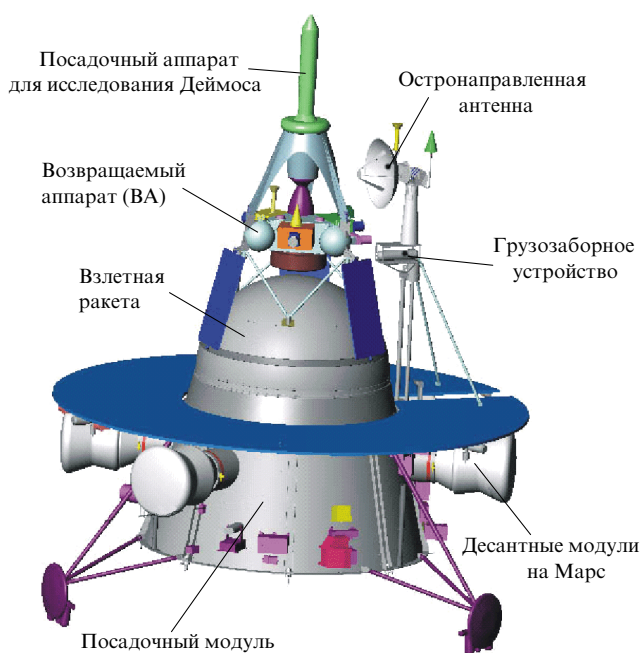
Рис. 6. Проект космического аппарата нового поколения "Фобос-Грунт", являющегося базовым КА, на основе которого планируются полеты к другим малым телам солнечной системы.
