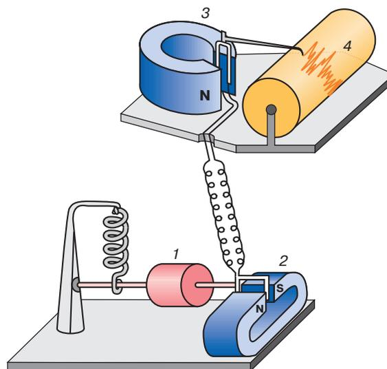
**Рис. 4.** Схема строения сейсмографа (по В.И. Улову, 1971) и сейсмограмма землетрясения: 1 – маятник, 2 – рамка маятника в поле постоянного магнита, 3 – стрелочный гальванометр, 4 – рулон бумаги на барабане и перо, рисующее колебания (сейсмограмму)
