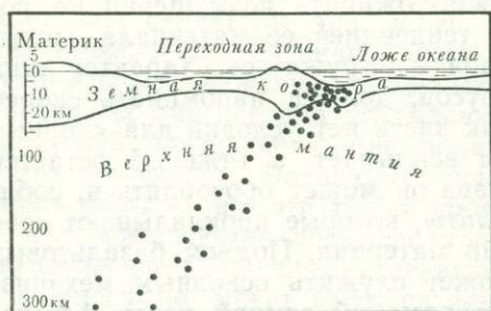
Рис. 10. Распределение очагов землетрясений (черные кружки) под переходной зоной
