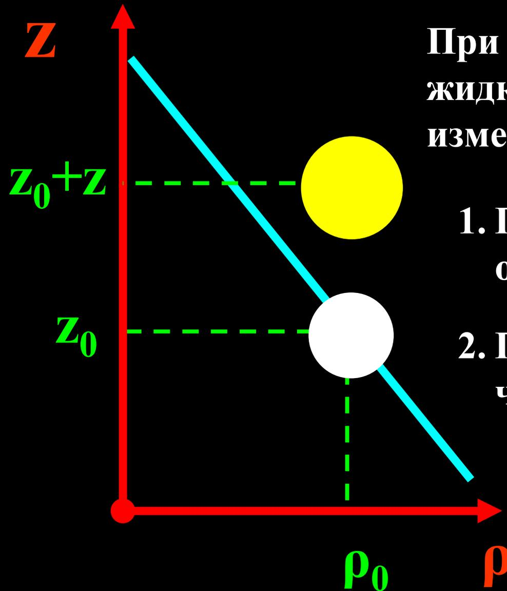
При ее смещении частицы жидкости по вертикали на  $Z$  изменяются:
