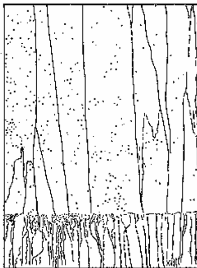
Рис. 5.2. Фронтальная граница двух различных форм кристаллов льда.
