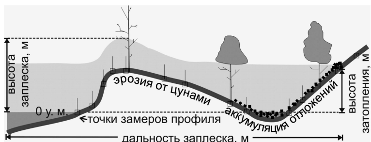
Рис. 6.9. Схема замеров основных характеристик проявления цунами вдоль топографического профиля
