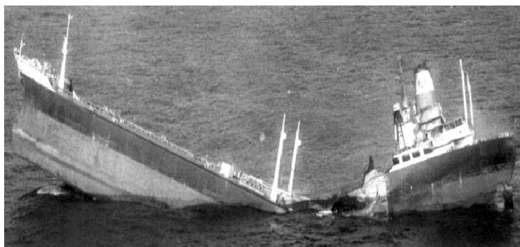
Рис. 1.7. Фотографии разрушений кораблей после встречи с волнами-убийцами [Куркин, Пелиновский, 2005]
