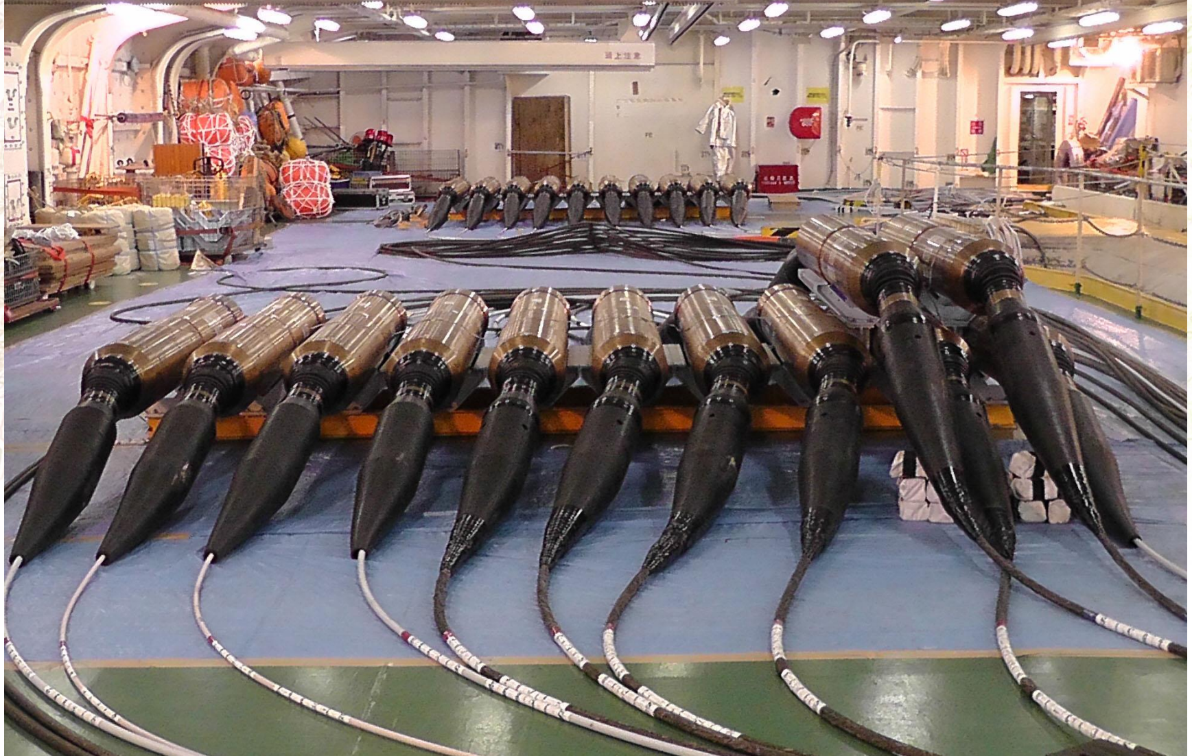
2013年7月6日 ケーブルタンク上のデッキに収納された地震津波計。手前の12台が茨城県鹿嶋市側から設置するもので、奥の10台が千葉県南房総市側から設置するものです。（提供：防災科学技術研究所）
