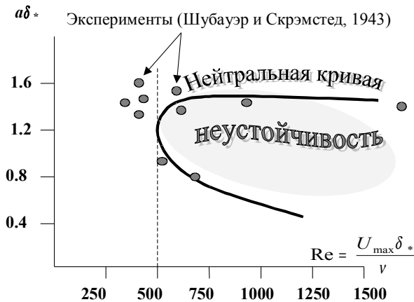
Рис. 1.8 Зависимость волнового числа возмущений, нормированного на толщину слоя вытеснения, от числе Рейнольдса
