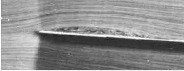
Рис. 1.14 Пластинка, обтекаемая потоком. Фото ONERA. [Werle, 1974]
