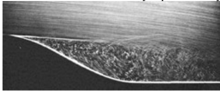
Рис. 1.15 Поток жидкости над искривленным дном. Фото ONERA. [Werle, 1974]
