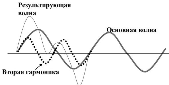
Рис. 4.9 Сложение волн в системе без дисперсии. Передний фронт волны становится круче, а задний – положе.
