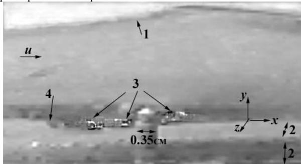
Рис. 5.4 Деформация песчаного дна под неподвижной волной на ускоряющемся вдоль по течению стационарном потоке воды. 1 – поверхность воды, 2 – дно, 3 – вихри, 4 – левый край размывтой ямы.
