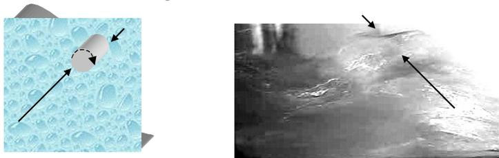
Рис. 5.39 Силы, действующие на единицу поверхности вихря со стороны воды и воздуха. Справа на кадре видеозаписи виден вихрь, вылетевший с заднего склона волны.
