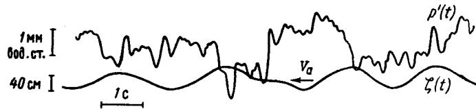
Рис. 4.7. Пример записи волн и пульсаций давления ветра
