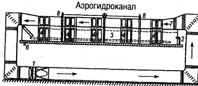
Рис. 6.5.2. Схема аэрогидроканала: 1 — вентилятор, 2 — кран, 3 — подвижный пол, 4 — смотровое окно, 5 — волногаситель, 6 — сливное отверстие, 7 — сопло, 8 — подъемный механизм
