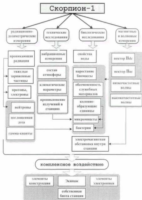
Рис.4. Основные параметры, регистрируемые аппаратурой СКОРПИОН-1
