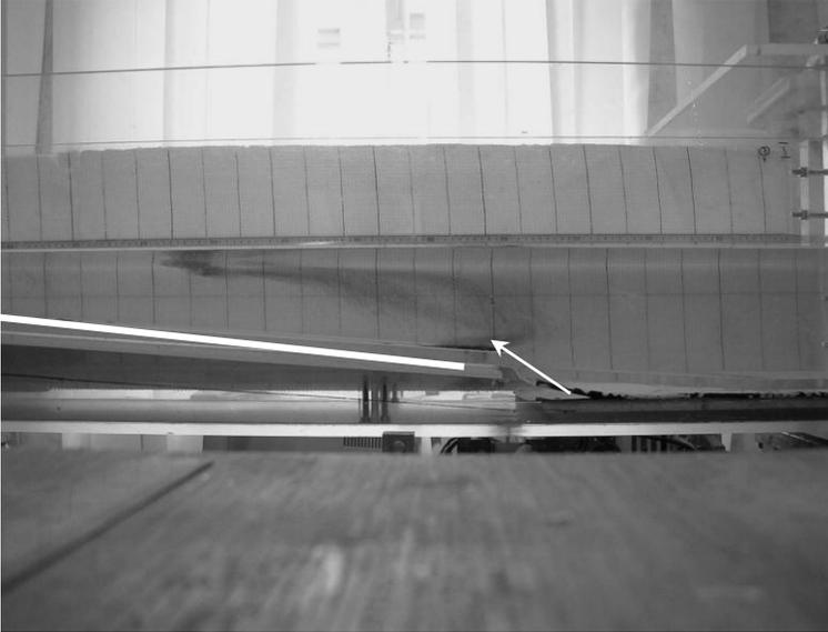
Рис. 11. Процесс отрыва придонного течения от склона дна по результатам лабораторного эксперимента в лотке. Толстой линией обозначен уклон дна. Тонкая линия указывает на проникновение интрузии в промежуточный слой.
