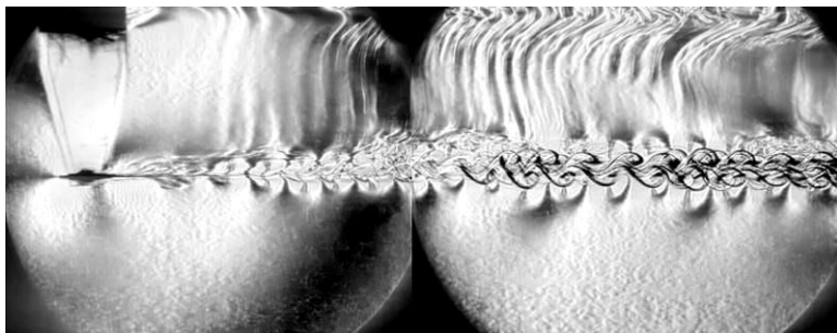
Рис. 5. Формирование и распад вихрей за пластиной в стратифицированной жидкости
