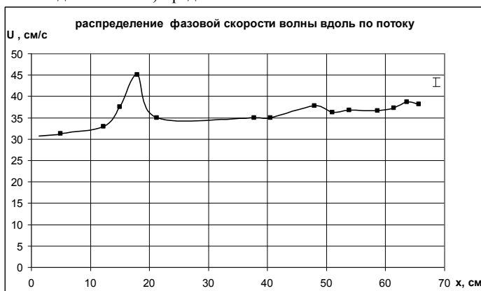
Рис. 1. Зависимость фазовой скорости волны от разгона. Здесь и далее отрезками показаны доверительные интервалы, рассчитанные в области максимальной дисперсии, с вероятностью 0,67.
