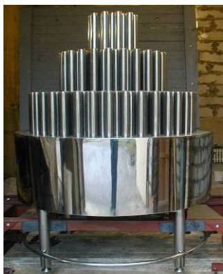
Рис.8. Модель капиллярного конденсора
