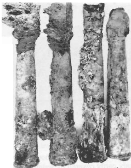
Рис. 5. Коррозия корпусов гранат по [9].
