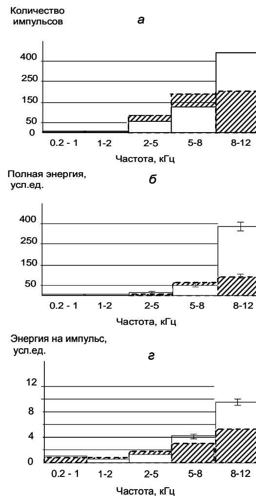
Рис.4. Количество импульсов геоакустической эмиссии в зависимости от частоты в период наблюдения аномалий и в период их отсутствия (а); полная энергия геоакустической эмиссии в зависимости от частоты, в период наблюдения аномалий и в период их отсутствия (б); средняя энергия, приходящаяся на один импульс в период наблюдения аномалий и в период их отсутствия (в). Период отсутствия аномалий показан штрихованной линией.
