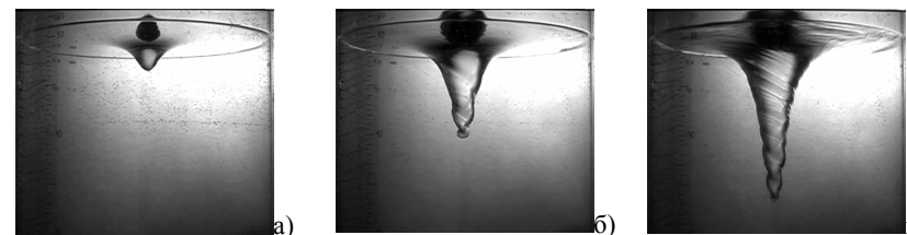
Рис. 3. Форма свободной поверхности установившегося вихревого течения в цилиндрической обечайке радиуса R_0 = 14.8 см, глубина жидкости H = 50 см, радиус индуктора r = 5.0 см,
