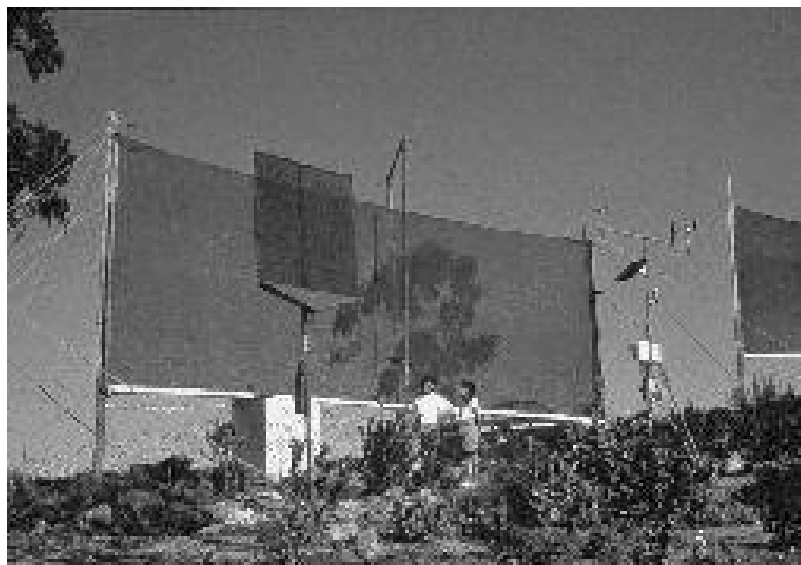
Рис. 3. Коллектор для улавливания росы (Оман).
