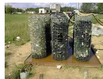
Рис. 6. Габрионы установки «РОСА МГУ»
