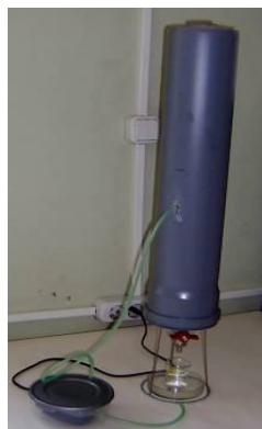
Рис.9. Капиллярная колонка конденсора
