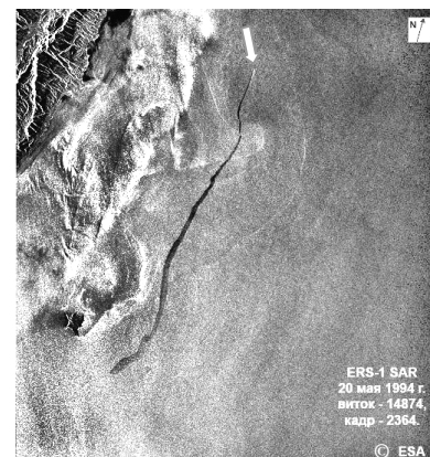
Рис. 2 – Нефтяной след (темная полоса), тянущийся за судном (яркая точка, отмечена стрелкой). Длина следа превышает 80 км. Координаты центра кадра: 23°01'N, 121°41'E. Размер кадра: 100 км × 100 км [15]
