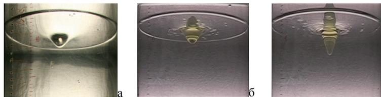
Рис. 4. Поверхность составного вихря с малой добавкой легкой жидкости на малой частоте вращения активатора ( $H=40$  см,  $R=7.5$  см): а) –  $\Omega=377$  об/мин,  $V_k=0$  мл; б) –  $\Omega=250$  об/мин,  $V_k=30$  мл; в) –  $\Omega=240$  об/мин,  $V_k=60$  мл.
