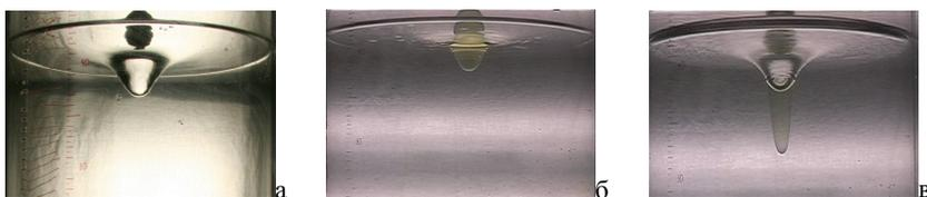
Рис. 5. Различия динамики роста поверхностной каверны с малой добавкой легкой жидкости на свободной поверхности ( $H=40$  см,  $R=7.5$  см,  $\Omega=500$  об/мин): а) –  $V_k=0$  мл; б) –  $V_k=30$  мл; в) –  $V_k=60$  мл.
