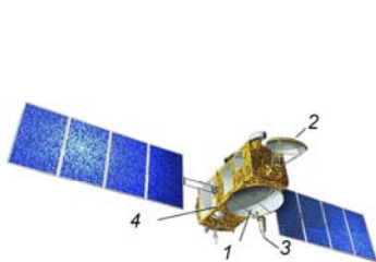
Рис. 4. КА «Jason-1». 1 – антенна альтиметра; 2 – антенна радиометра; 3 – антенна системы DORIS; 4 – лазерный отражатель.
