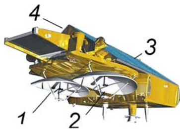
Рис. 6. КА «CryoSat-2». 1, 2 – антенны альтиметра-интерферометра; 3, 4 – солнечные батареи.
