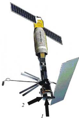
Рис. 1. КА «SEASAT». 1 – антенна альтиметра; 2 – кольцо лазерных отражателей
