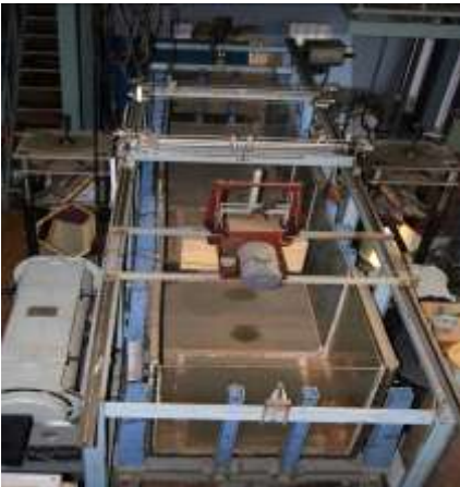
Рисунок 3. Бассейн стенда БЛИК 7×1.25×1.25 м с волнопродуктором, кареткой и теневым прибором ИАБ-463.
