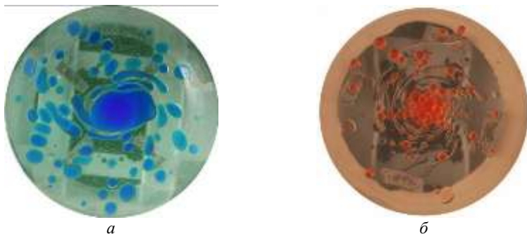
Рис. 9. Формы поверхностного пiana ( H = 40 см, V_k = 30 мл, \Omega = 310 об/мин): а, б) R = 5.0 см, R = 7.5 см.
