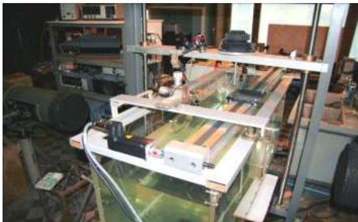
Рисунок 1. Стенд для моделирования эффектов в толще и на поверхности стратифицированной жидкости с аэро- и гидроакустической системой и теньевым прибором ИАБ-451 (ЭСВПШ).
