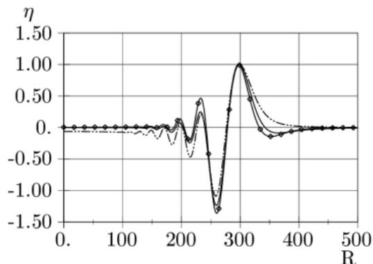
Результаты расчетов  $\eta$ ,  $\eta_F$  с параметрами  $b = 2$ ,  $t = 60$ ,  $|z_0| = 43$ ,  $D = 3$  в сравнении с возвышением, полученным по поршневой осесимметричной модели с  $l = 40$  (слева) и  $l = 15$ , (справа).
