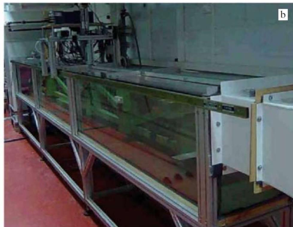
Экспериментальные каналы в ТельАвивском университете для исследования защитных свойств затопленных барьеров
