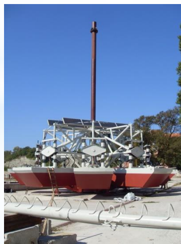
Буй – волновой генератор электроэнергии (Очаковский комбинат ЖБИ)
